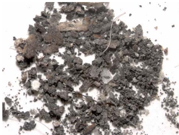
Рис. 4. Минеральная взвесь из образца снега, собранного в районе Второй речки. Увеличение \times 18
