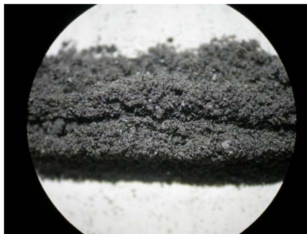
Рис. 8. Минеральная взвесь из образца снега, собранного в районе бухты Тихой. Увеличение \times 18
