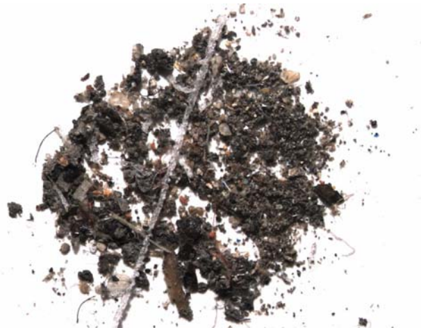
Рис. 3. Минеральная взвесь из образца снега, собранного в районе ул. Пушкинской. Увеличение \times 8
