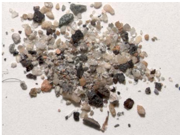
Рис. 1. Минеральная взвесь из образца снега, собранного на полуострове Шкота. Увеличение \times 16
